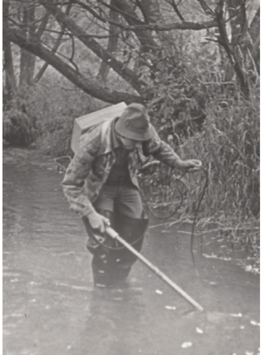
Otfried Wüstemann führt sein selbstgebautes Elektrofanggerät während des ichthyofaunistischen Seminars 1985 in Wendefurt/Harz vor. Foto: Hans-Joachim Paepke
