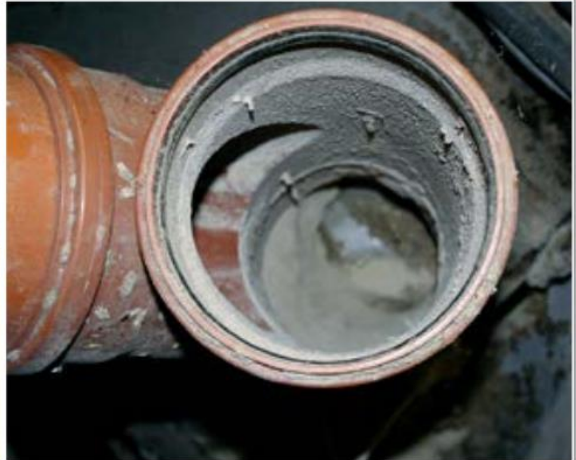
Bilder 49 und 50: Die Dosiereinrichtung und Förderrohre müssen sauber und frei von Ablagerungen sein, um Verschneidungen von medikiertem Futter zu vermeiden. Hier sieht man schlechte Beispiele.
